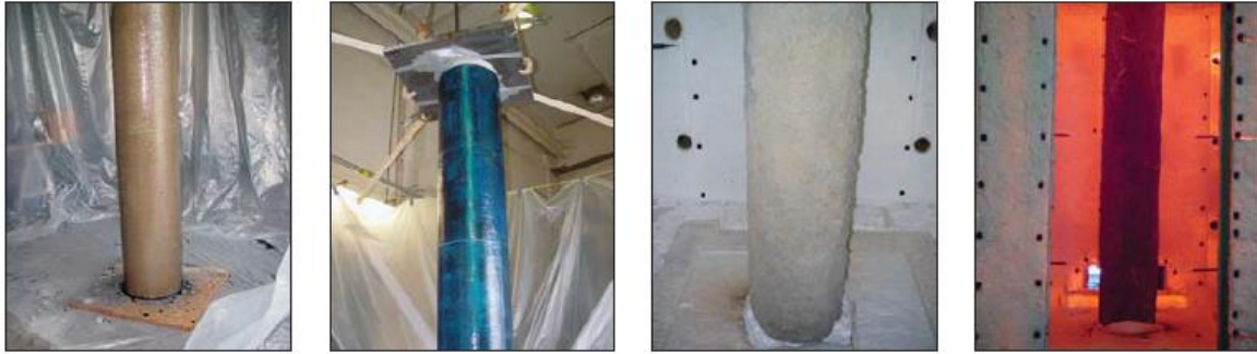
Σχήμα 3: Προετοιμασία και δοκιμή κυκλικού υποστυλώματος από Ο.Σ σε υψηλή θερμοκρασία [8]
